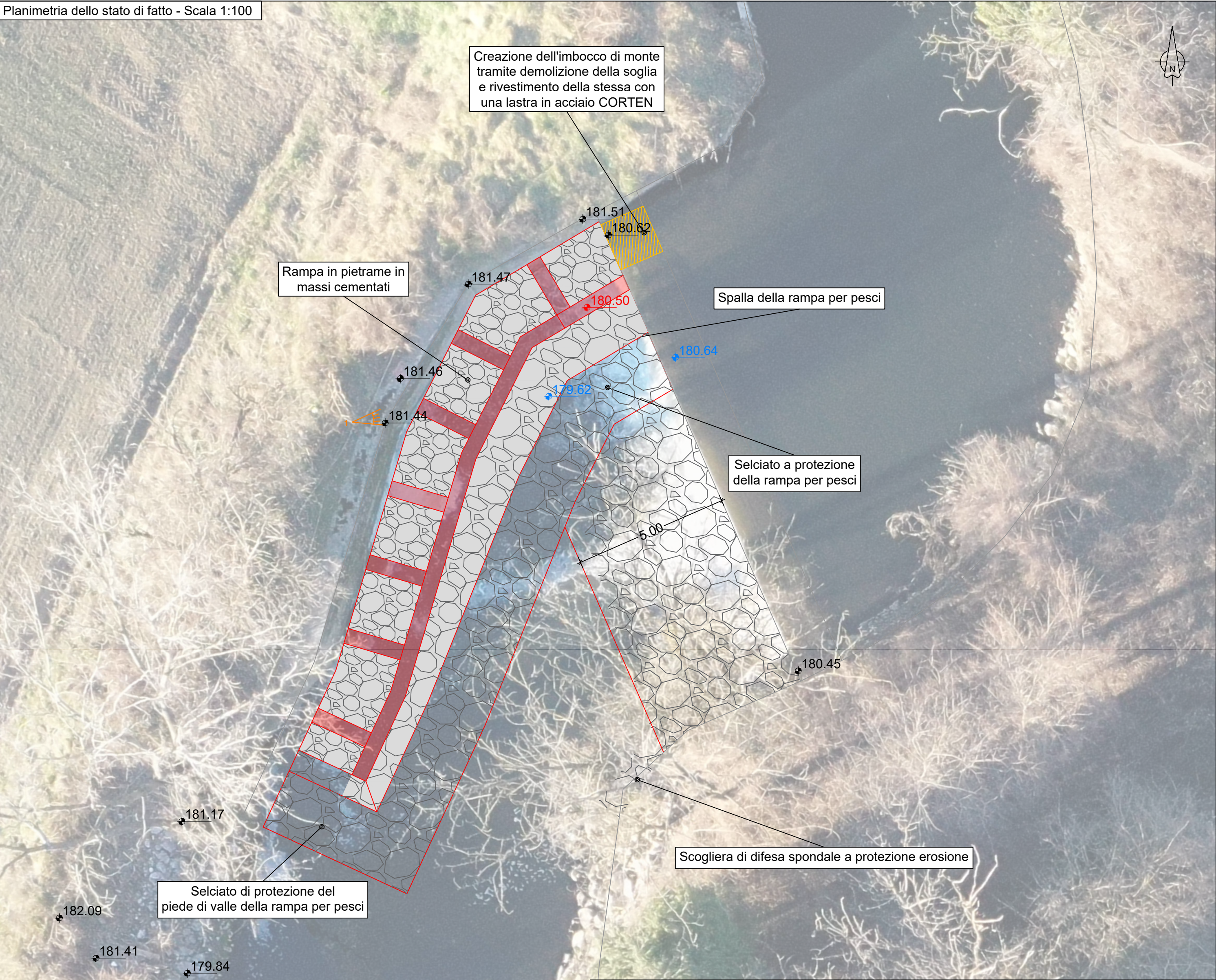
Parametri geometri del passaggio per pesci
